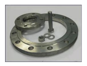
Может быть из нержавеющей или углеродистой стали в зависимости от диаметра трубопровода. На рабочее давление до 16 кгс/кв.см (стандарт). На Ду от 15 до 500 мм (стандарт). Состоит из двух ответных фланцев, болтов, гаек и шайб.
